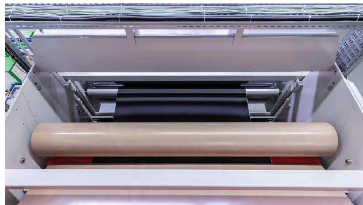
**D** Diese auf 60°C erwärmte Walzeinheit bewirkt eine ebenmäßige Kaschierung ohne zusätzliche Spannungen und negative Einflüsse auf die Oberfläche.
