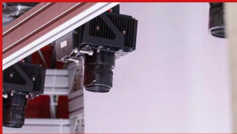
**D** Im laufenden Betrieb erfolgt über hochauflösende Kameras eine Kontrolle der produzierten Ware auf der Produktionsstraße in Echtzeit.
