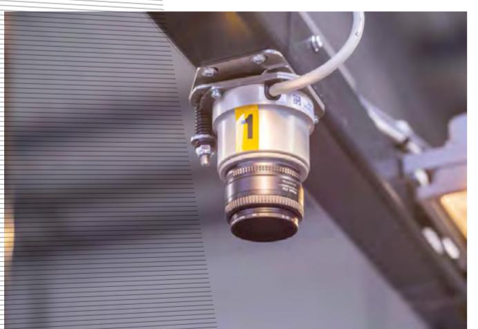
**D** Die Anzahl der Fäden wird permanent überwacht. Eine technische Meisterleistung.
