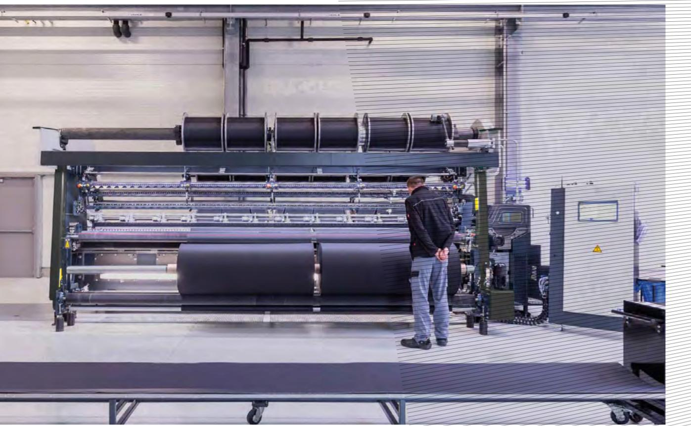
**D** Auf der Wirkmaschine laufen alle Fäden nach vorgegebener Programmierung zusammen.
