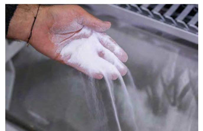
**D** Der Kleber auf Pulverbasis ermöglicht eine präzise Dosierung und neue Möglichkeiten in der Applikation.
