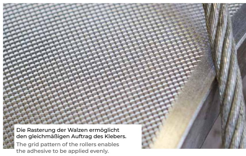
Die Rasterung der Walzen ermöglicht den gleichmäßigen Auftrag des Klebers.
